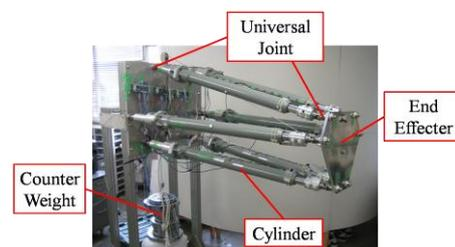
図 3. 開発したマニピュレータ
