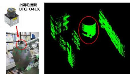
図 4. (左) 測域センサ, (右) 形状計測結果
