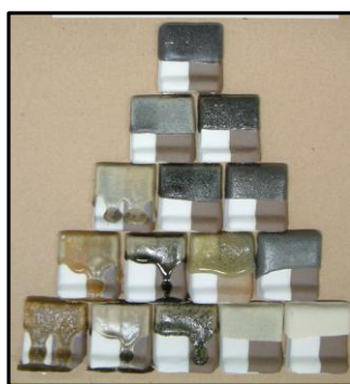
釉薬調合試験の例【三角座標：福島長石-スラグ-珪石／蛙目粘土 10%（外割）】
