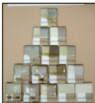
釉薬調合試験の例【三角座標：福島長石-スラグ-珪石／蛙目粘土 10%（外割）】
