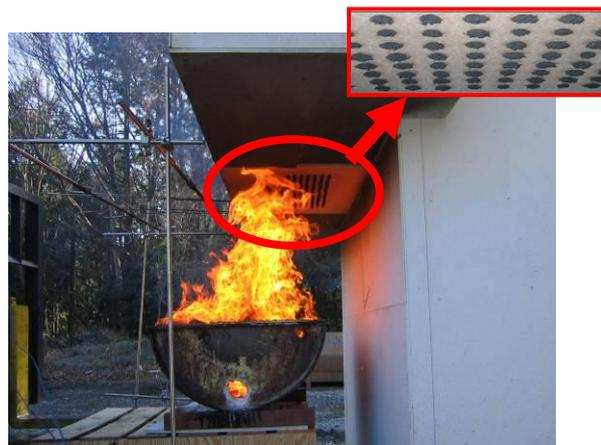
試作した軒天井の火炎暴露試験を実施した。実験終了後に通気孔の閉塞を確認（上図の赤で囲んだ部分）
