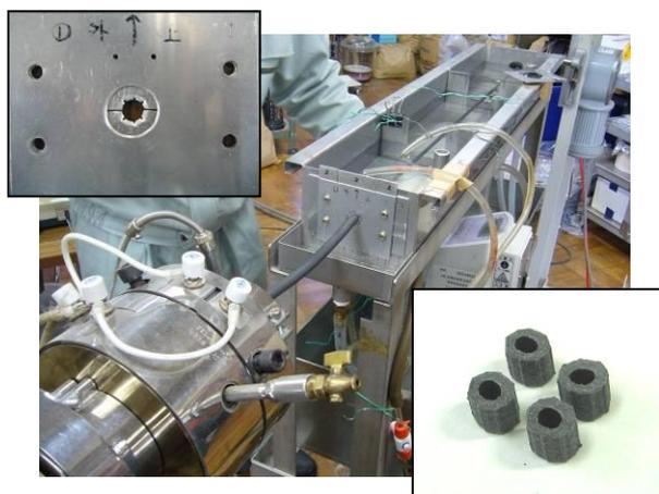
熱膨張性難燃チューブの作製、凸付きサイジングダイ(上左)、落下防止を考慮したコマ(下右)
