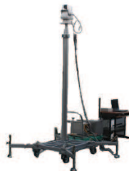
劣化部近距離撮影型
