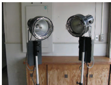
図 1 人工太陽照明灯
