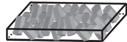
結晶方位のランダム化および微細化による塑性加工性の向上
