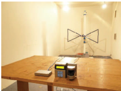
図1 試験風景(放射エミッション試験)
