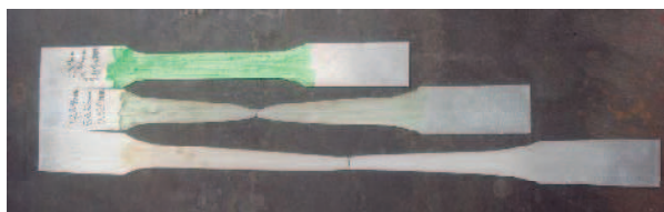
温間引張（300℃）：上.元寸 中.速度 5mm/min マグネシウム合金（AZ31） 下.速度 0.5mm/min
