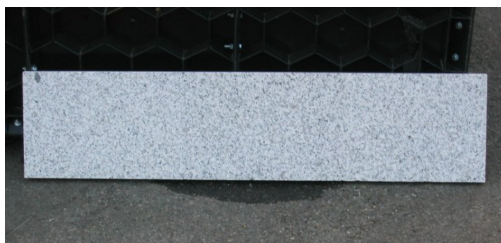
図. 光触媒コーティングを施した石材タイル （中央付近3分の1をコーティング）
