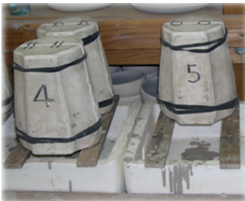
写真 1：鋳込み成形による製品作り
