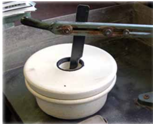
写真 2：機械ろくろによる製品作り
