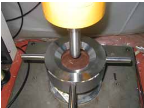
写真 1 物性試験 (破裂強度)
