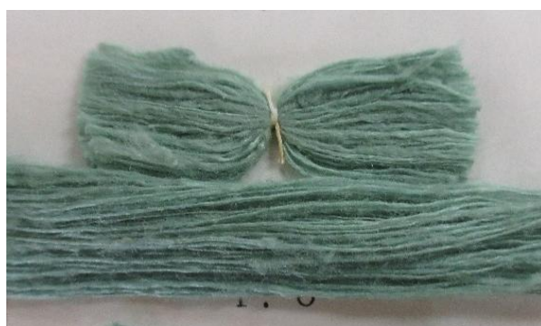
図5 5段階濃度による染色試験
