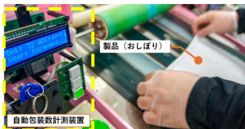
図5 おしぼり包装の様子と自動計測装置
