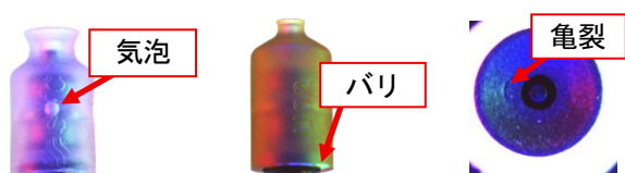
図2 取得した吸着パッド画像の例 (左図、中央図：側面写真、右図：上面写真)
