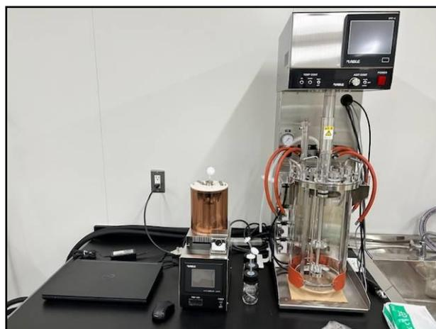
図3 納豆菌の液体培養に用いた菌体制剤化システム(ジャーファーマンターとオートサンプラー)
