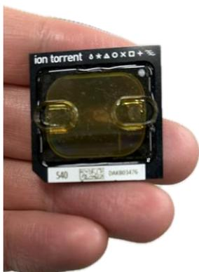
図5 次世代シーケンサーに使用する半導体チップ
