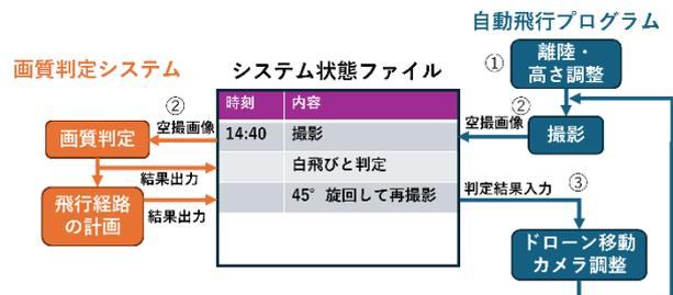
図3 検証用再撮影システムのアルゴリズム
