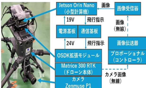
図2 ドローンのハードウェア構成
