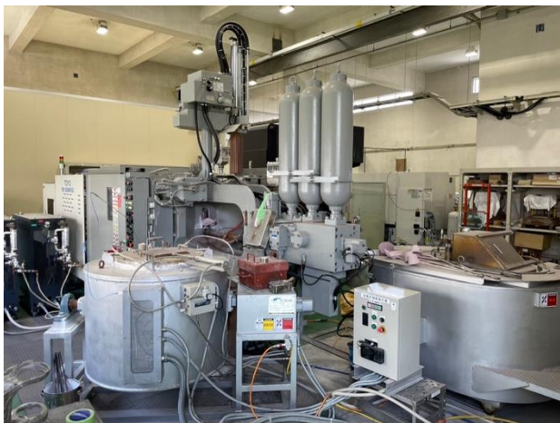
図 1 350 トンダイカストマシンシステム
