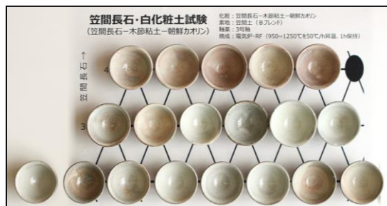
図2 白化粧土試験片（笠間土・還元焼成）
