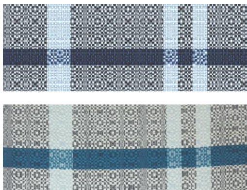
図 1 製織シミュレーション結果 (上：シミュレーション 下：試作)
