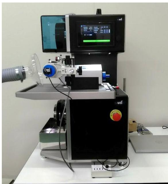
図6 ダイヤモンドワイヤー切断機
