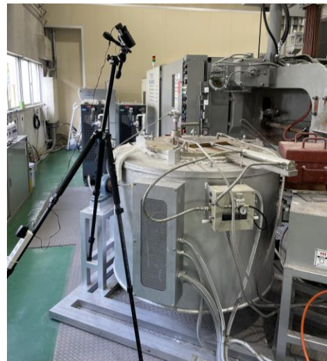
図 3 防燃ガス評価に用いた溶解炉
