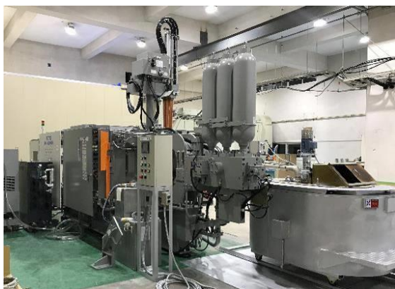
図1 ダイカストマシンシステム（350トン）
