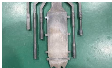
図2 試験片用金型で成形した各種試験片
