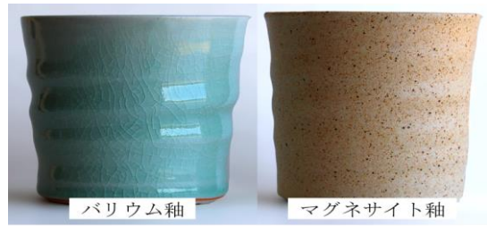
図2 融材変化方式釉薬試験で得られた釉薬例
