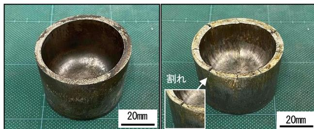
加工速度 0.1mm/s 加工速度 1.0mm/s (b) 超音波付加
