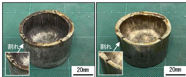
加工速度 0.1mm/s 加工速度 1.0mm/s (a) 超音波無し
