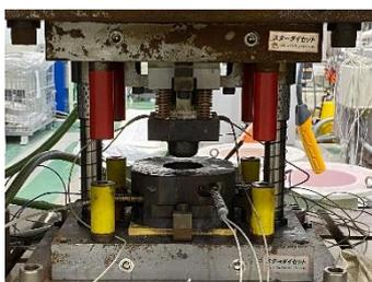
図5 鍛造用金型外観
