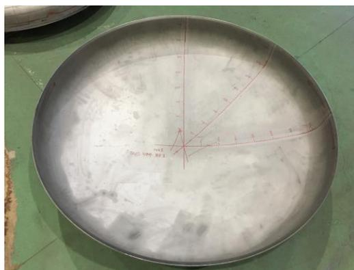
図2 改良金型による実機での成形品
