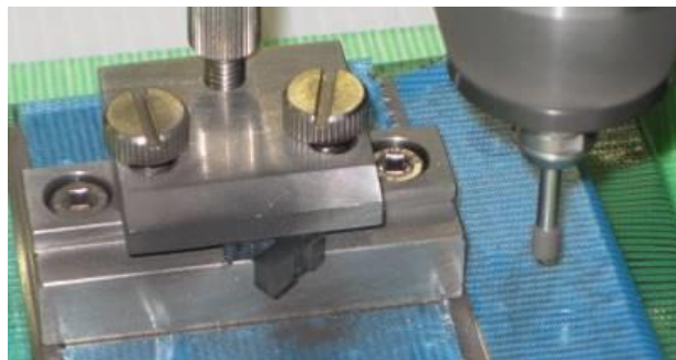
図 6 層間剥離の様子
