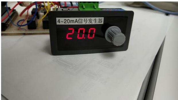
図 2 可変電流発生器
