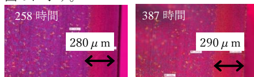
図 5 PP 条件 1 のスキン層断面観察結果
