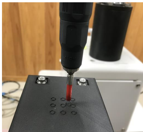
図5 ロボットによるバリ除去
