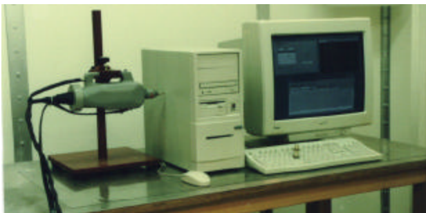
写真1 静電気放電試験の様子
