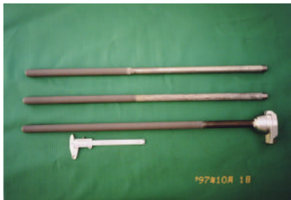
図9 溶射被膜作製状況と被膜作成後の温度計保護管
