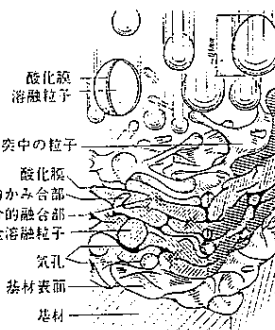
図1 溶射被膜形成のモデル図
