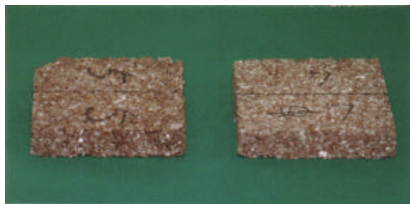
図8 試作透水性タイル
