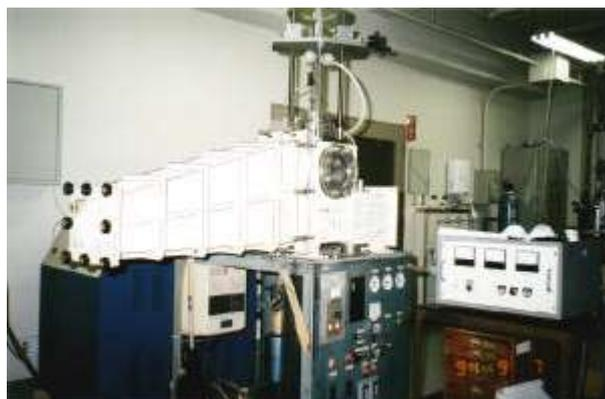
図1 液体急冷装置（単ロール法）
