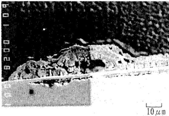
図4 Auめっき上の腐食部分の断面SEM像
