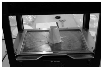
図 3 石膏型へのシートの圧着
