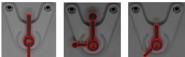
図4 治具に固定した部品の認識結果
