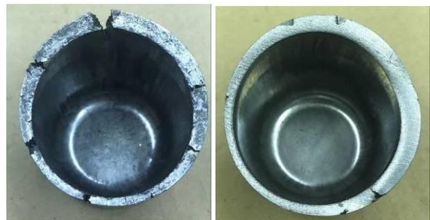
鍛造温度： $200^\circ\text{C}$  鍛造温度： $400^\circ\text{C}$
