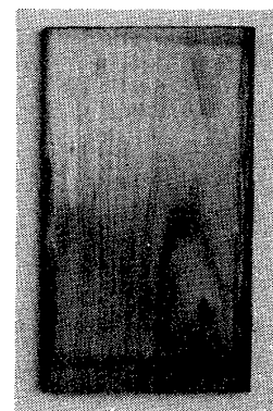
図4 フッ素樹脂表面処理材自然暴露試験片(ヒノキ材)
