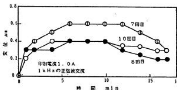
図5 バイアス応力 5 \text{ kg f/mm}^2 で106回繰り返し負荷の GMA の変位変化
