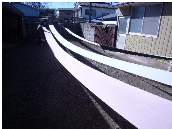
図5 糊抜き後の乾燥工程(吊り干し)
