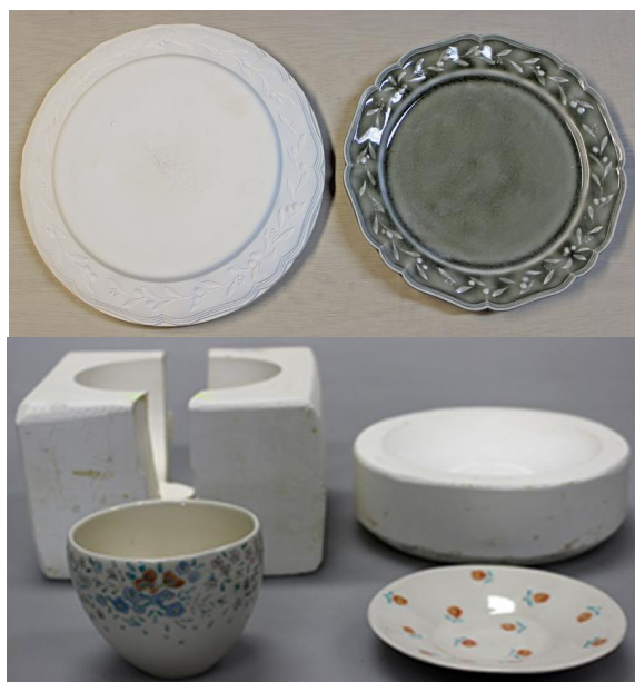
図5 石膏型を使った新製品 上) オリーブレリーフ皿, 下) 絵付けの器
