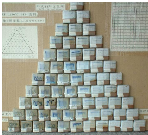
図1 三角座標形式による釉薬試験例
