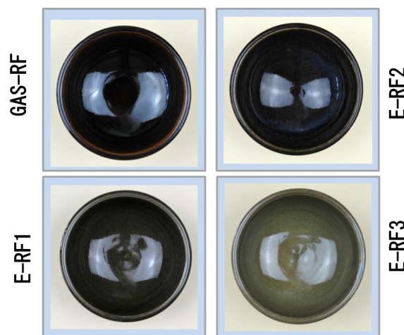
図4 焼成品比較 酸化鉛釉 白土
