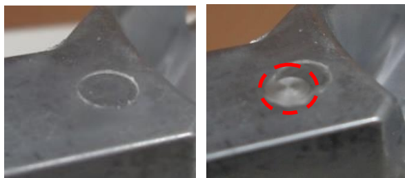
(a) 仕上げ前 (b) 仕上げ後 (点線で囲まれた部分が研磨箇所) 図12 仕上げ処理前後のバリ
