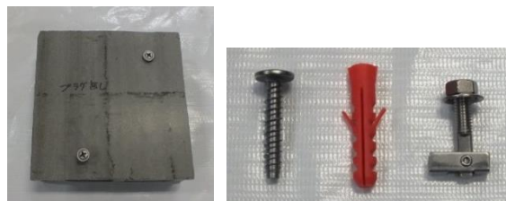
図3 メース板(左)と締結具(右) (締結具は左から、スクリュー、プラグ、ITハンガー)
