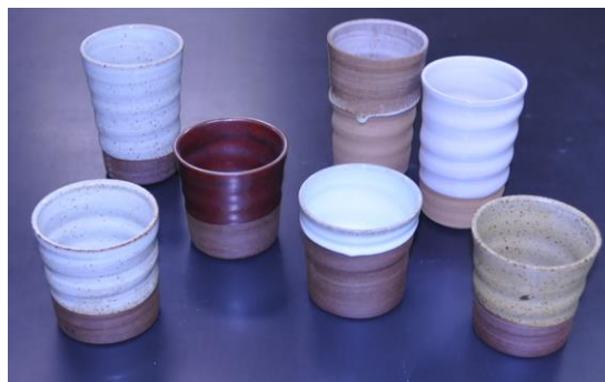
図1 H28 試験焼成品の例: ガス窯/赤土
