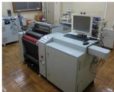
図2 小型レピア試織機（CFRP 試織機）
