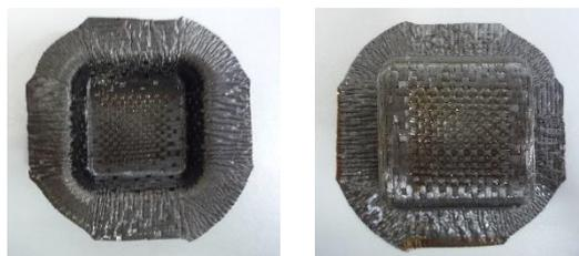
図 14 プレス成形加工実験結果
