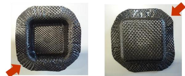
図 10 プレス成形加工実験結果 (平織のみ)
