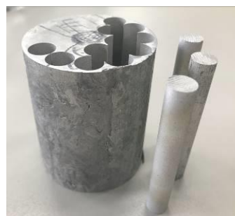
図 4 鑄物材より採取した円柱試験片外観
