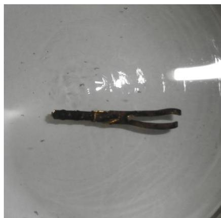
図 2 チオ尿素による使用済み部品からの浸出(表面が黒色のような状態となっている)
