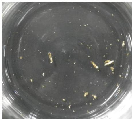
図5 硝酸および塩酸処理後の金めっき
