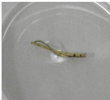
図3 塩酸による使用済み部品からの浸出
