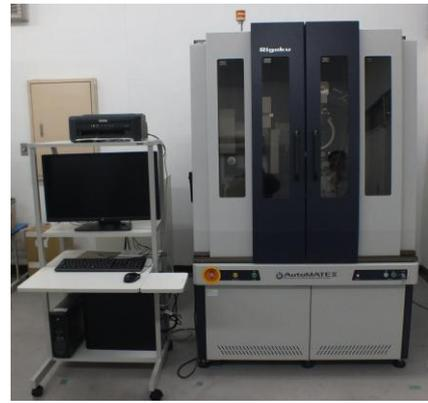
図5 チタン対応非破壊材料構造解析システム
