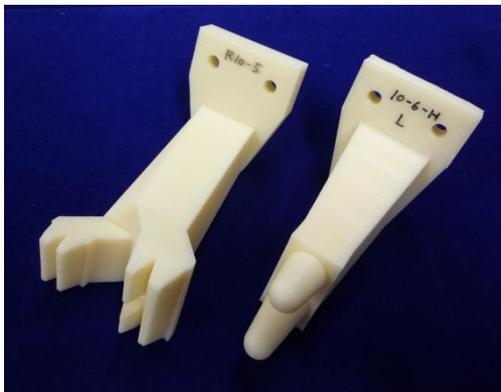
図1-2 造形したロボット指②
