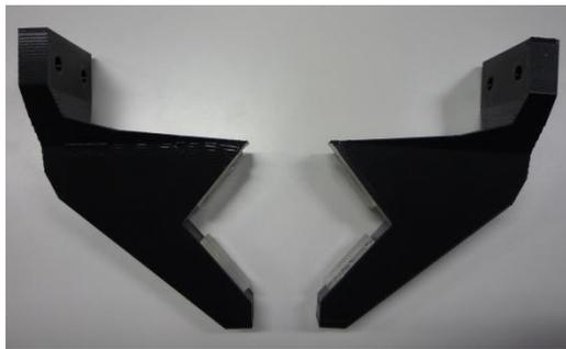
図1-1 造形したロボット指①
